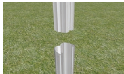
①参考図の通り、打ち込んだ柱の地上部にセパレート用の支柱を差し込みます。
